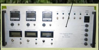
Analyseur d'Isoprène (FIS) : Il fonctionne avec un générateur d'ozone et utilise le phénomène de chimiluminescence. La réaction chimique entre l'isoprène et l'ozone produit un photon. Nous utilisons un photomultiplicateur pour compter les photons et remonter à la concentration d'isoprène dans l'échantillon d'air prélevé.
