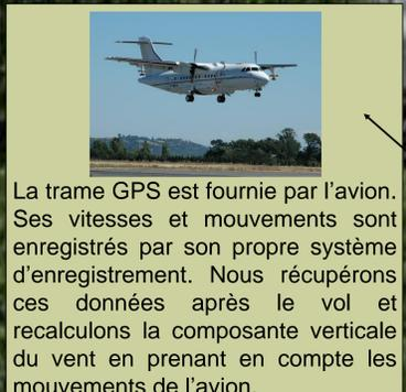
La trame GPS est fournie par l'avion. Ses vitesses et mouvements sont enregistrés par son propre système d'enregistrement. Nous récupérons ces données après le vol et recalculons la composante verticale du vent en prenant en compte les mouvements de l'avion.
