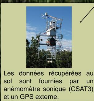
Les données récupérées au sol sont fournies par un anémomètre sonique (CSAT3) et un GPS externe.
