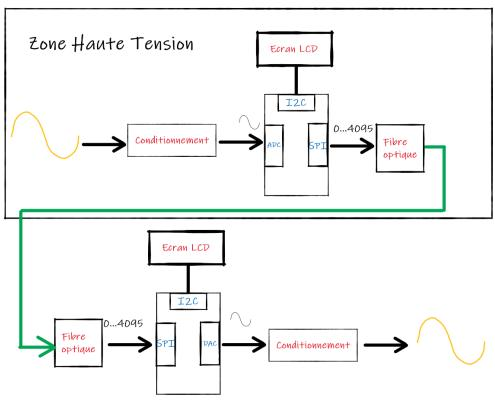
Mesure de courant isolée Haute tension avec option de gain programmable
