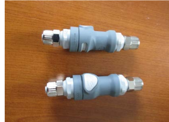
raccords stop-goute pour démontage du circuit de refroidissement
