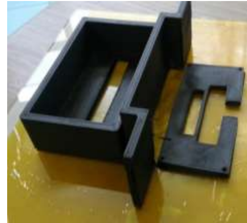
Pièces du capot thermique après impression
