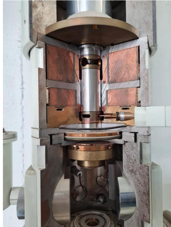
Mise en forme et positionnement du faisceau
