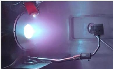
Dispositif du balayage de la plume Plasma
