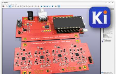
CAO : Ex. PCB 16 voies ADC  $\Delta \Sigma$  16-bits
